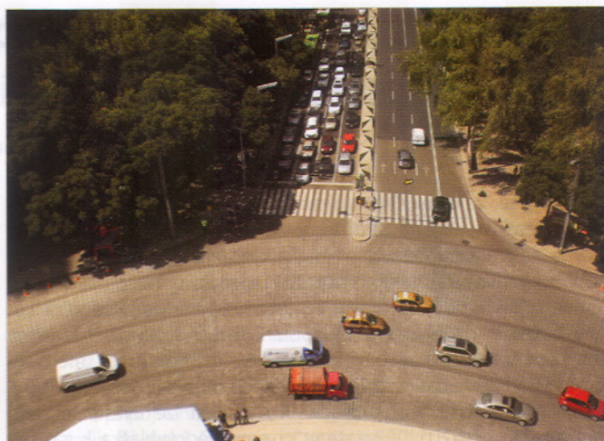
Obrázek 7: Vozidla krouží v protisměru po polovině kruhu.
