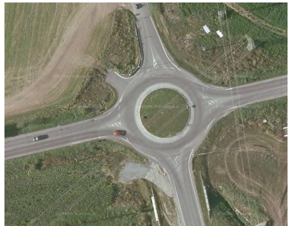
Obr. 6: Silnice II/611 x III/33310 – chybný tvar křižovatky
